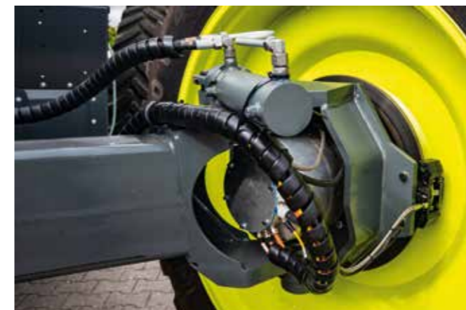
Elk wiel van de EOX 175 heeft een eigen elektromotor.
